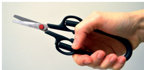
Tesoura adaptada - a pessoa fecha a tesoura, que volta para a posição aberta
