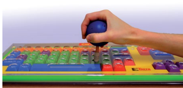
Colmeia para teclado - facilita a digitação para pessoas com dificuldades motoras
